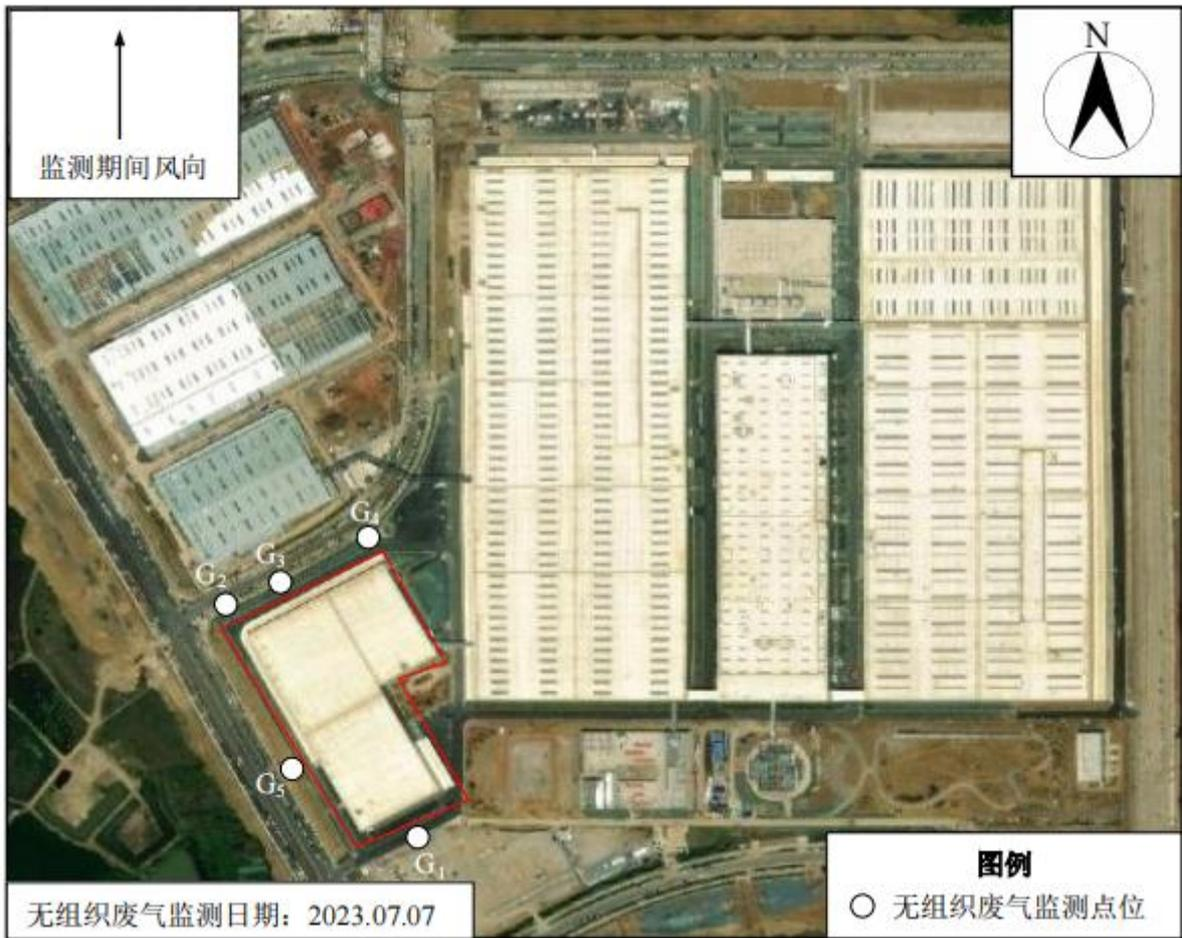
图 6-2 无组织废气验收监测点位布设示意图（2023.7.7）
