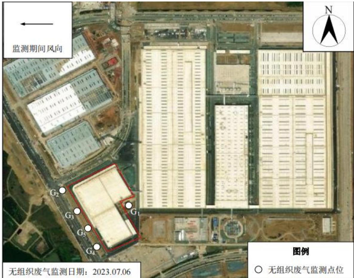
图 6-1 无组织废气验收监测点位布设示意图 (2023.7.6)
